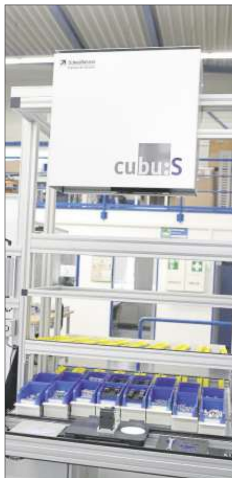
Lichtsignale leiten an diesem manuellen Montagearbeitsplatz die Prozesse an und kontrollieren sie.
